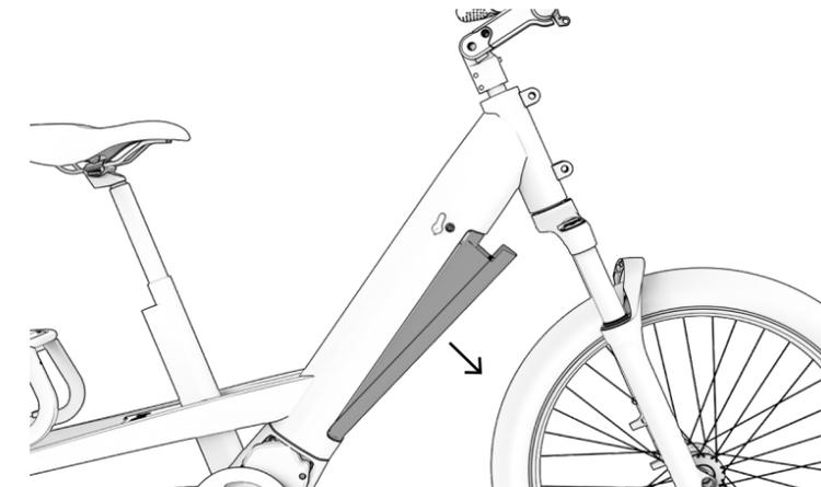
4. COLOCA EL ADAPTADOR EN EL CARGADOR PARA PODER CONECTARLO A LA BATERÍA.
