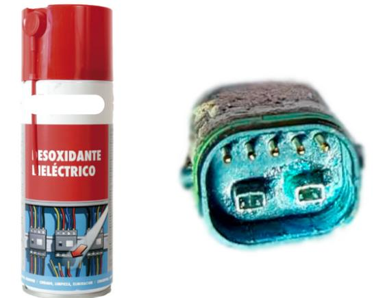
⚠ Cuando una conexión eléctrica entra en contacto con humedad o está tupidada debido a una contaminación externa, se produce una reacción química por la cual las conexiones se sulfatan. Es decir, el cobre de los contactos se oxida, provocando fallos de conductividad.
